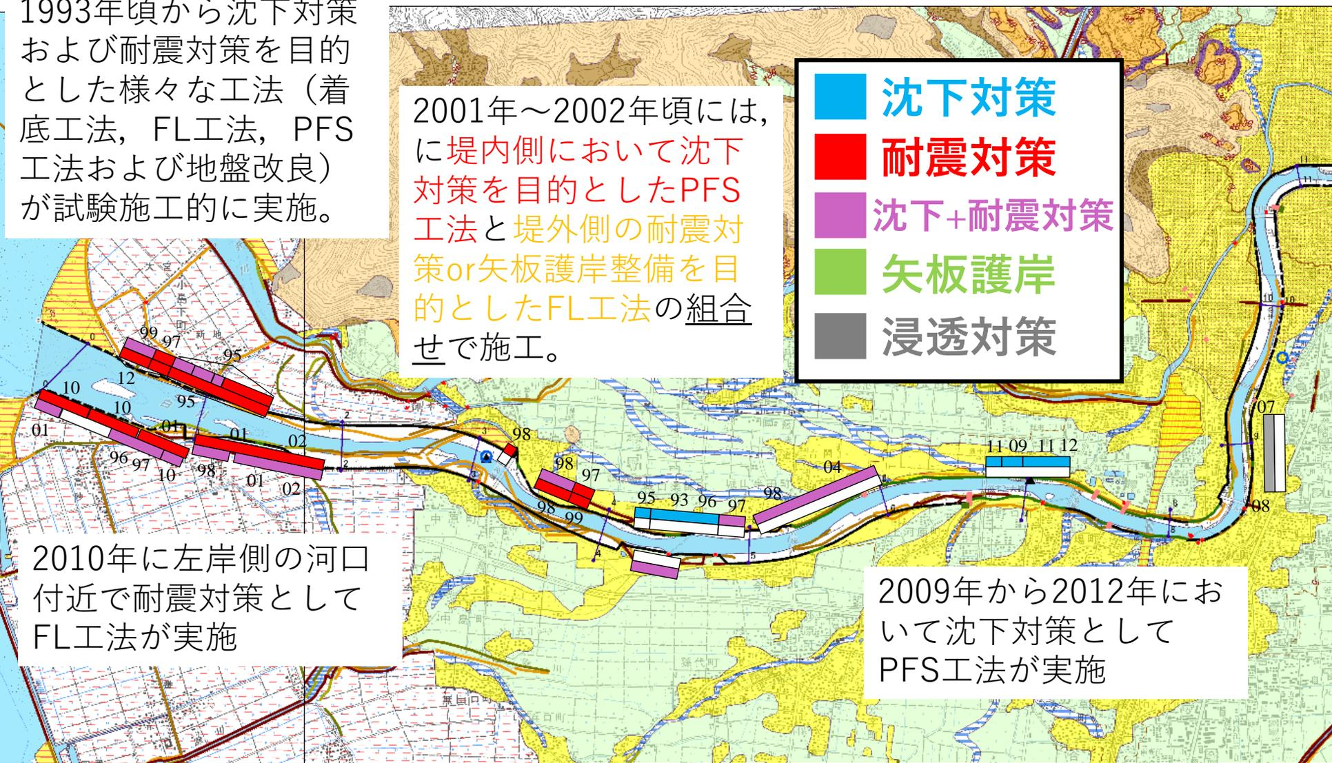
緑川は、震災以降の2012～2014年にかけて堤内側において沈下対策を目的としたPFS工法と堤外側の耐震対策or矢板護岸整備を目的としたFL工法の組合せで施工
