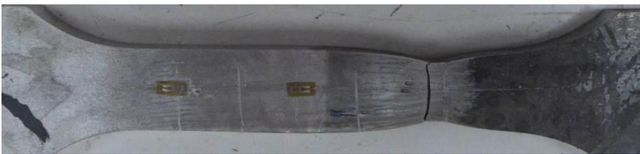
いずれの組み合わせも炭素鋼母材で破断
