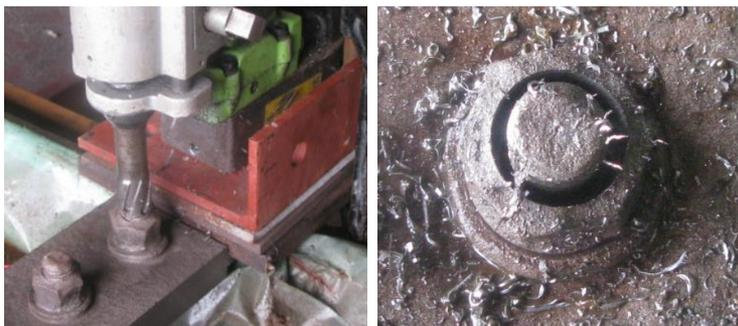
軸力計測方法: コア抜き
