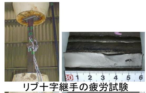
リブ十字継手の疲労試験
