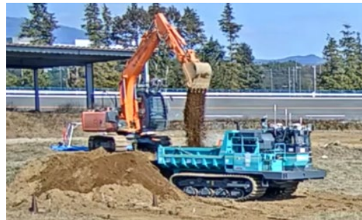
無人重機による自動化・自律化 実証試験
