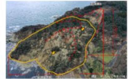
地すべり・斜面崩壊(逢坂トンネル坑口埋没)
