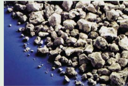
鉄鋼スラグは、工場生産による安定した品質をベースに、省エネルギー・省資源、CO<sub>2</sub>削減を可能にする「地球にやさしい資材」として利用されています。鉄鋼スラグ製品は、高炉セメントやコンクリート用骨材、道路用路盤材、土工・港湾用、地盤改良材、肥料、ロックウールなど社会の基盤作りに欠かせない製品となっており、その多くはグリーン購入法指定調達製品に指定されています。
