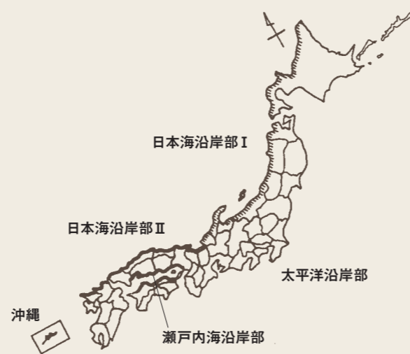
JIS耐候性鋼を無塗装で使用する場合の適用可能地域 (文献6)
