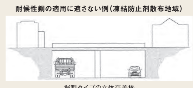
掘割タイプの立体交差橋
