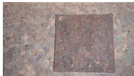
さびサンプルによる評価 (外観評点2)
