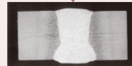
大入熱溶接継手の例(1パス 入熱量 150kJ/cm)
