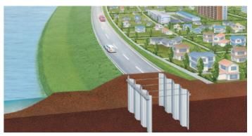
堤防や盛土内に鋼矢板を設置し、地盤との複合構造とすることで、 災害に対して強固な河川や海岸の堤防を構築する工法
