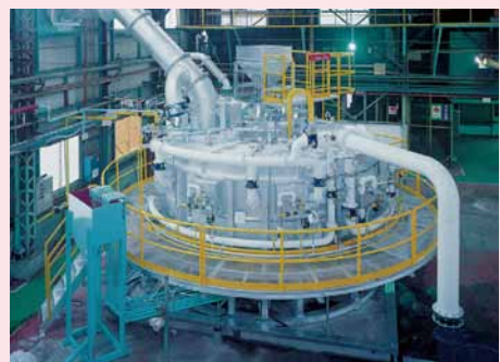
回転床炉を用いたダストリサイクルプロセス (INMETCOプロセス) (写真提供:大同特殊鋼(株))
