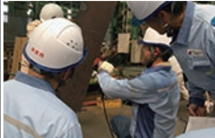
エッジを出すためにアングルの削り具合を検証する
