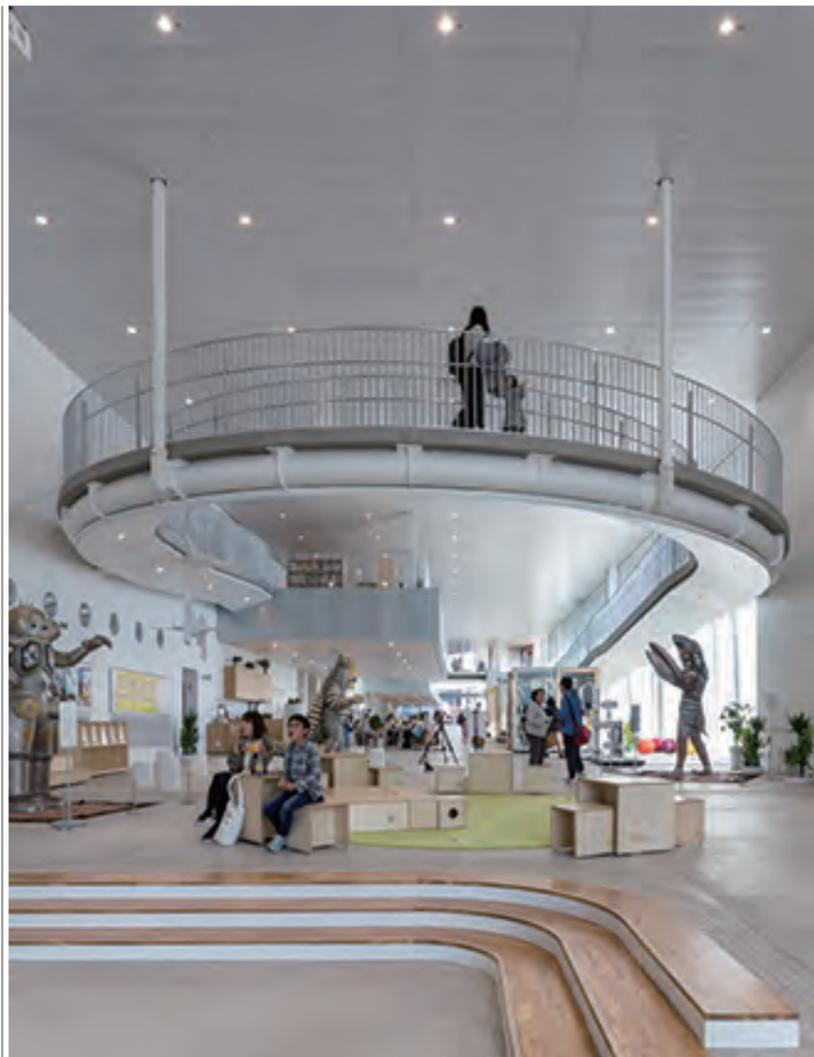
1階のtette通り 2階に繋がるスロープのU字部分は3階のメガストラクチャーから吊られている
