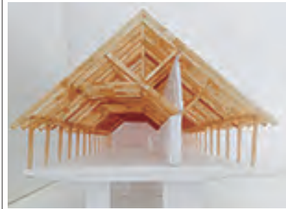
③登り梁の断面を最小断面とする木造架構案
