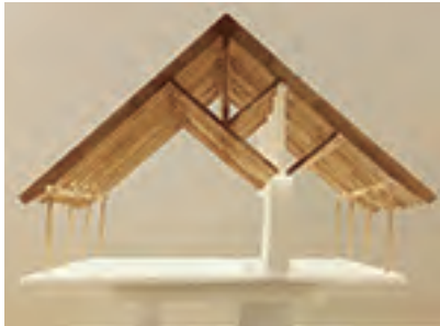
②木造架構を三角形で構成し、RC上部に鉄骨を内蔵した案
