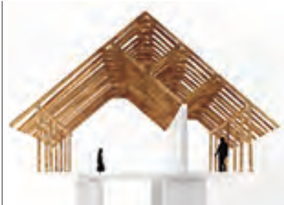
①設計初期の模型 RC造の壁と木造だけで構成されている
