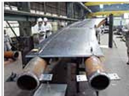
鋼管に鋼板を溶接したスパイラルフレーム
