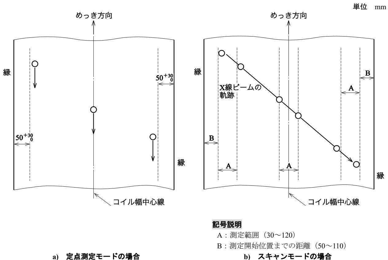
図 JD.1—めっきの付着量の測定位置
