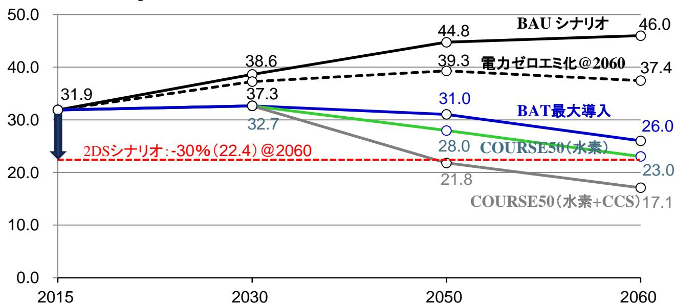
電力セクターのゼロエミ化が達成され場合、製鉄プロセスで消費する系統由来電力がゼロエミとなる。
