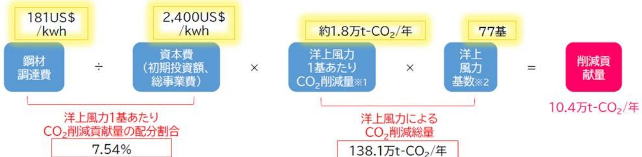
※1 「洋上風力1基あたりCO<sub>2</sub>削減量」は比較対象(リファレンス)となる2020年度の全電源CO<sub>2</sub>原単位(0.48kgCO<sub>2</sub>/kWh)と洋上風力のCO<sub>2</sub>原単位(0.03kgCO<sub>2</sub>/kWh)の差分により設定
