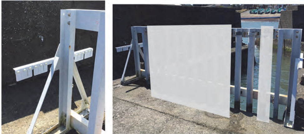
図8 設置時の小型暴露試験片および溶射鋼管架台全体
