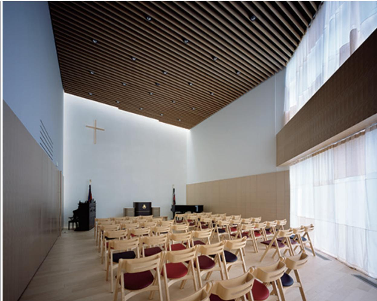
2階の礼拝堂 祭壇側（駒沢通り側）の壁面にはスリットを設け、礼拝の時間に自然光が入るように設計されている
