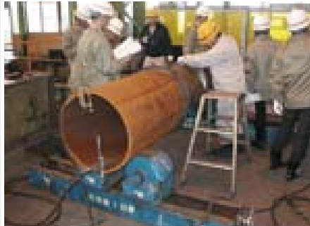
超高強度鋼管溶接試験状況
