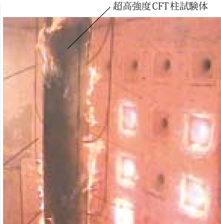
耐火実験状況
