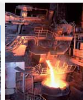
1600度 にアーク熱で熔解された電気炉スクラップ
